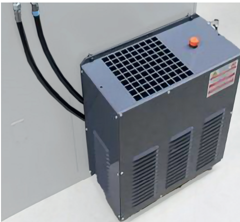
Circuit de refroidissement broche
